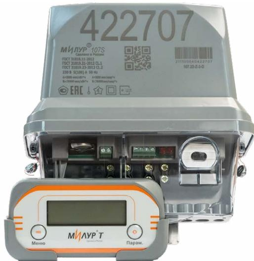
**Счётчик электрической энергии статический однофазный «Милур 107S» в корпусе SPLIT** для наружной установки, с реле управления нагрузкой и измерительным элементом в нулевом проводе (трансформатор тока), с поддержкой протокола СПОДЭС предназначен для учёта активной и реактивной потребляемой электроэнергии в двухпроводной сети переменного тока частотой 50 Гц.
