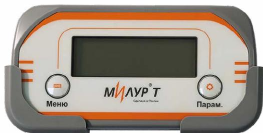
Блок индикации «Милур Т» предназначен для дистанционного считывания данных со счетчиков электрической энергии «Милур107» и «Милур307» в корпусе SPLIT.
